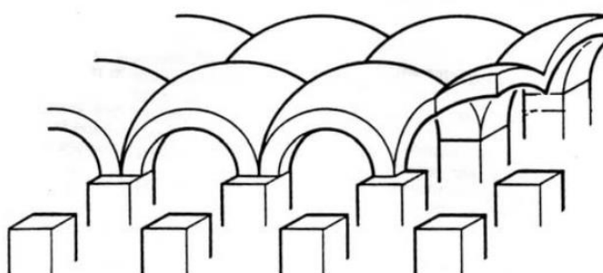
Figura 12: Modelo tridimensional do arqueamento (Hewlett e Randolph, 1988).
