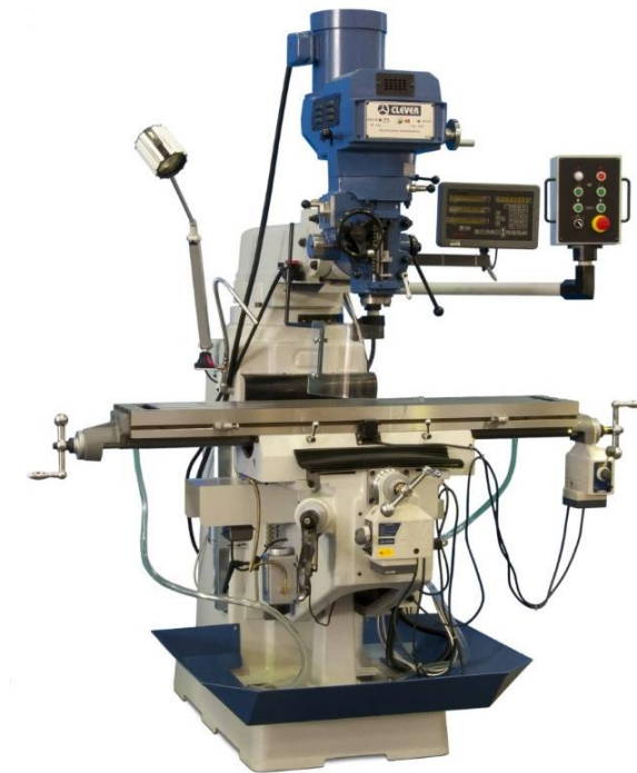
Figura 10 - Modelo de máquina fresadora utilizada para o processo de soldagem FSW
