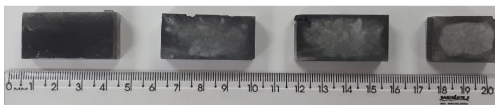
Figura 3 - Amostras atacadas com reagente Keller.
