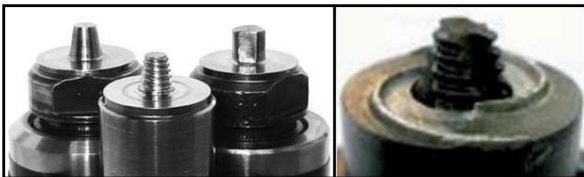
Figura 4 – Diversas geometrias do pino. Destaque para a ferramenta de ombro plano com estrias em forma de espiral
