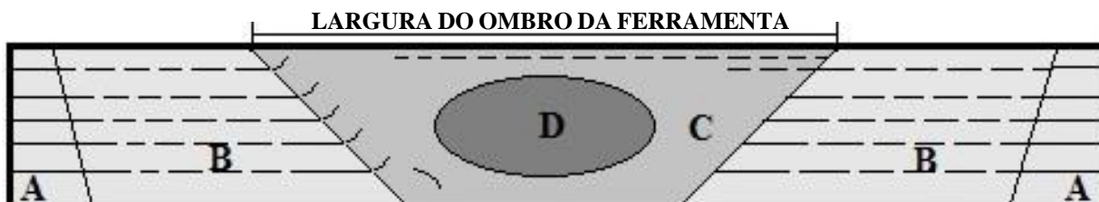
Figura 3 - Microestrutura típica da junta soldada por FSW
