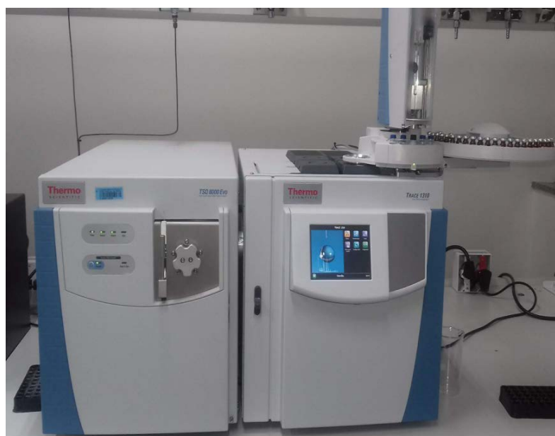
Figura 20: Cromatógrafo GC MS/MS TRIPLA QUADRUPOLO TSQ EVO 8000 E TRACE 1310 utilizado para a análise das substâncias químicas de interesse (SQI)
