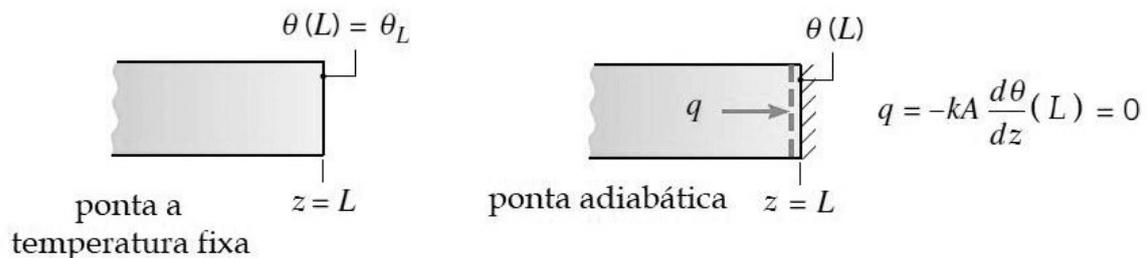
Figura 5 – Condições de contorno para a extremidade das aletas
