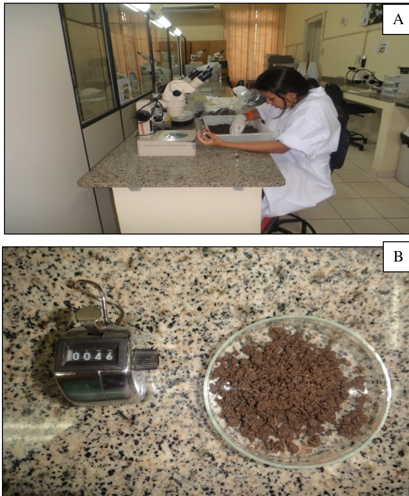
Figura 11 A-B - Procedimento de contagem dos juvenis no término do Ensaio de toxicidade crônica.
