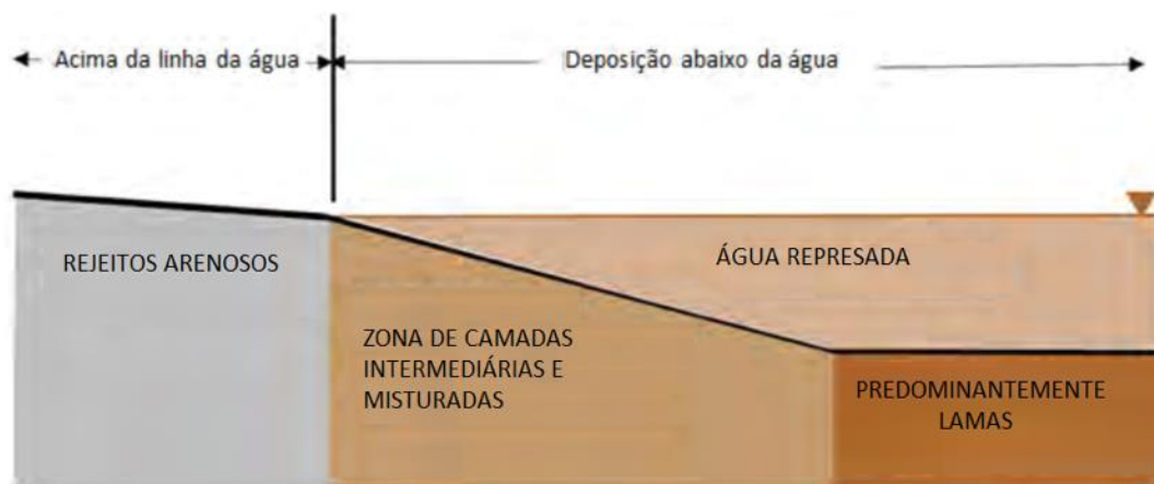
Figura 3 - Processo idealizado da deposição de rejeitos Fonte: Adaptado de Morgenstern et al. (2016)
