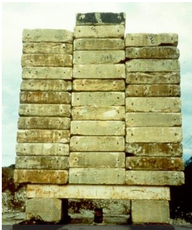
Figura 7 – Provas de carga com cargueiras (Valverde, 2011).
