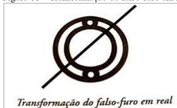
Figura 16 – Transformação do falso-furo em real
