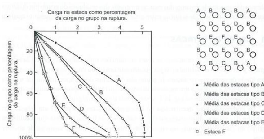
Figura 6 - Medição de cargas em estacas de um grupo (Velloso e Lopes, 2002, adaptado de Whitaker, 1957)
