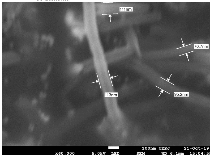
Figura 24 – Imagens de MEV feitas nas amostras de GPLA com 60.000X de aumento
