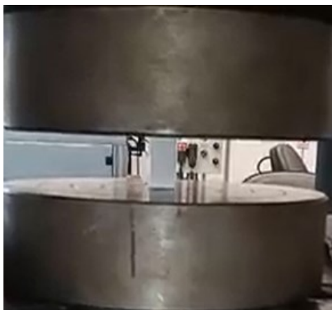
Figura 17 – Amostra de PLA sobre ensaio de compressão
