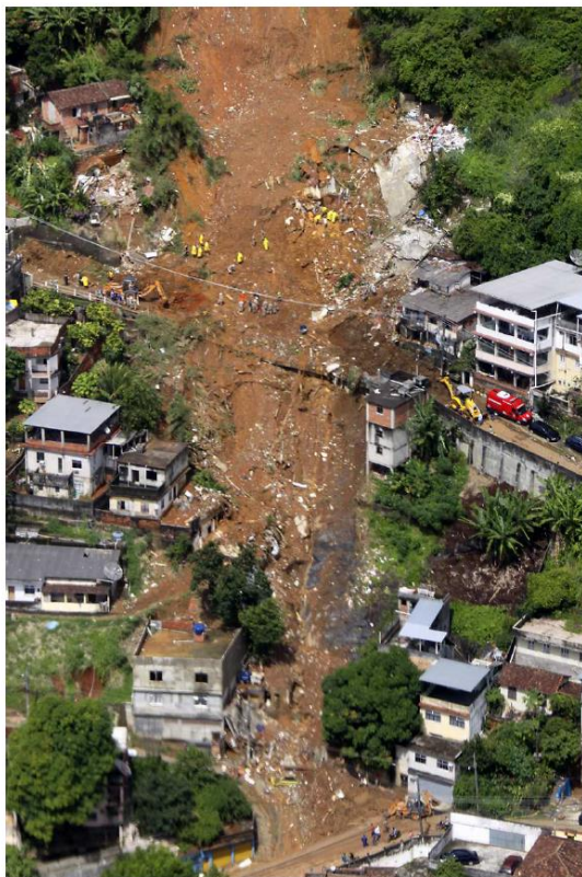
Figura 2 - (A) Escorregamento planar de solo em encosta no Morro dos Prazeres
