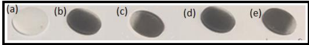
Figura 15 - Pastilhas de amostras de quitosana + KBr: a) quitosana sem pirolisar; b) pirolisada a 500 °C, c) pirolisada a 600 °C, d) pirolisada a 700 °C e e) pirolisada a 800 °C
