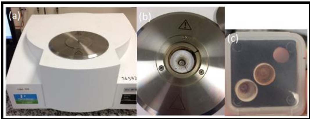
Figura 11 - Equipamento Simultaneous Thermal Analyzer utilizado na análise de TG/DTG (a), porta amostra (b) e os cadinhos (c)
