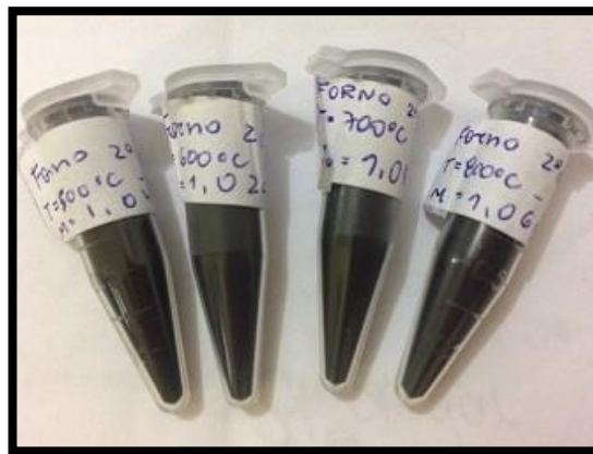
Figura 10 - Amostras de quitosana pirolisadas a 500, 600, 700 e 800 °C (da esquerda para a direita)
