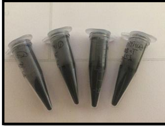
Figura 9 - Amostras de quitina pirolisadas a 500, 600, 700 e 800 °C (da esquerda para a direita)
