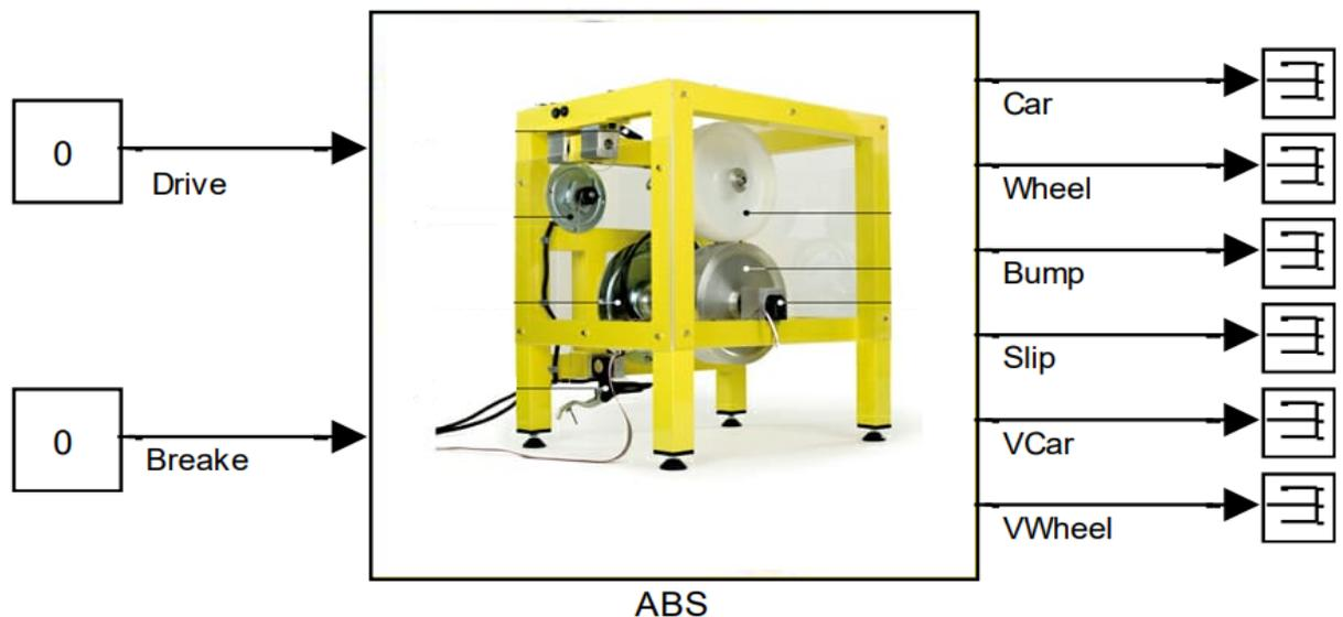
Figura 1 - Diagrama de Blocos do freio ABS da INTECO.
