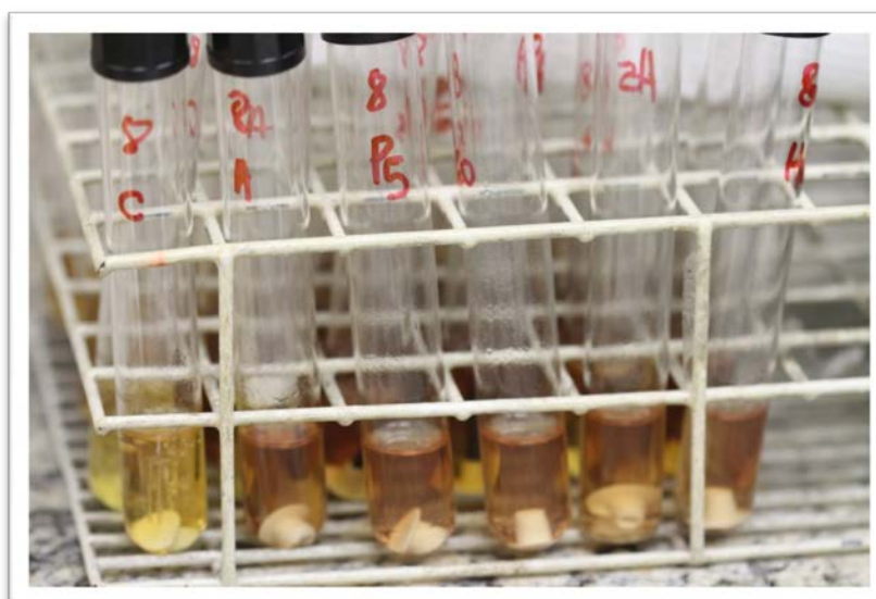
Figura 8 - Pontas polidoras após serem usadas e desinfetadas/esterilizadas em meio de cultura de tioglicolato
