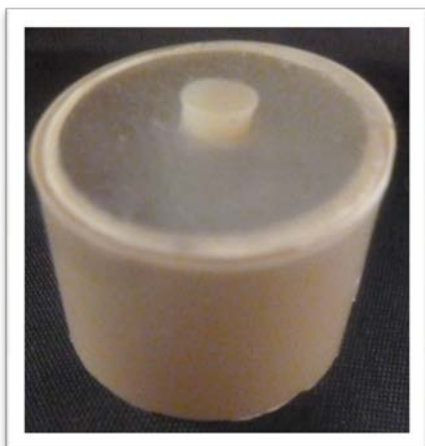
Figura 14 - Corpo de prova pronto para ser polido pelas pontas polidoras
