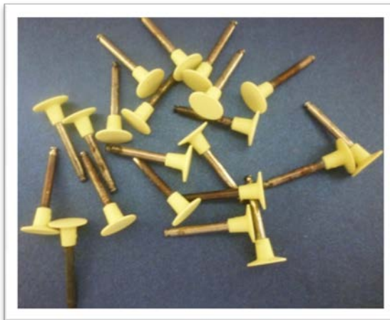
Figura 15 - Pontas DFL oxidadas após 48h imersas em meio de cultura
