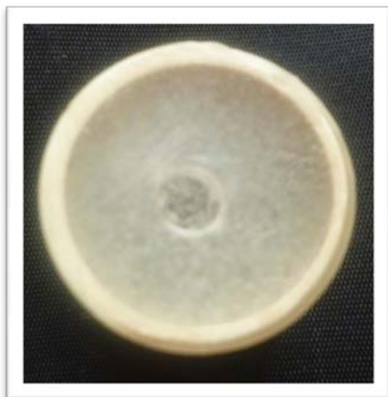
Figura 13 - Dispositivo que acoplava o corpo de prova para polir
