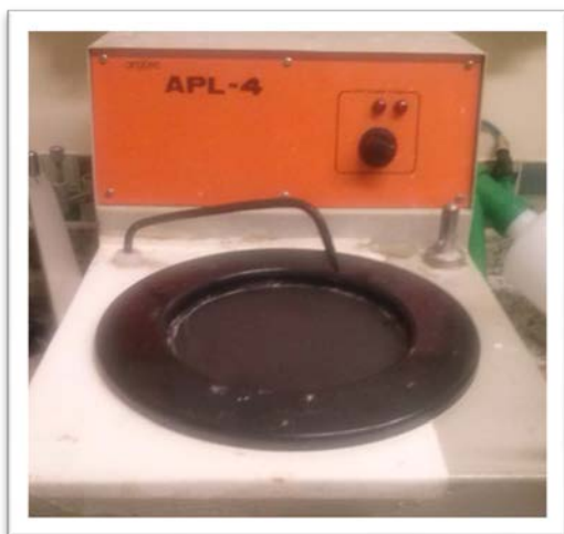
Figura 11 - Lixadeira mecânica Politriz (APL 04 AROTEC)
