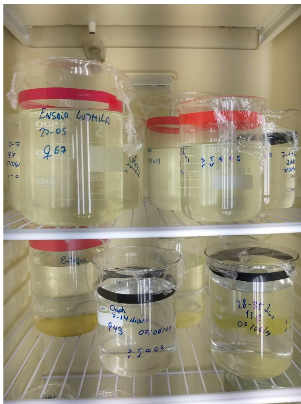
Figura 12 – Foto dos bécheres com cultivo de Daphnia similis em incubadora no Laboratório de Engenharia Sanitária da UERJ
