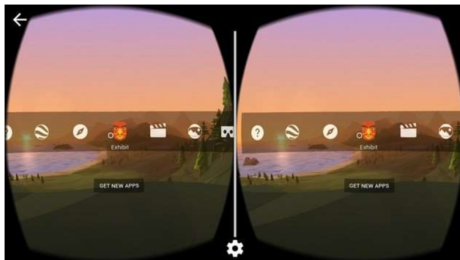
Figura 1 - Estereoscopia com duas imagens diferentes na visualização em HMD.
