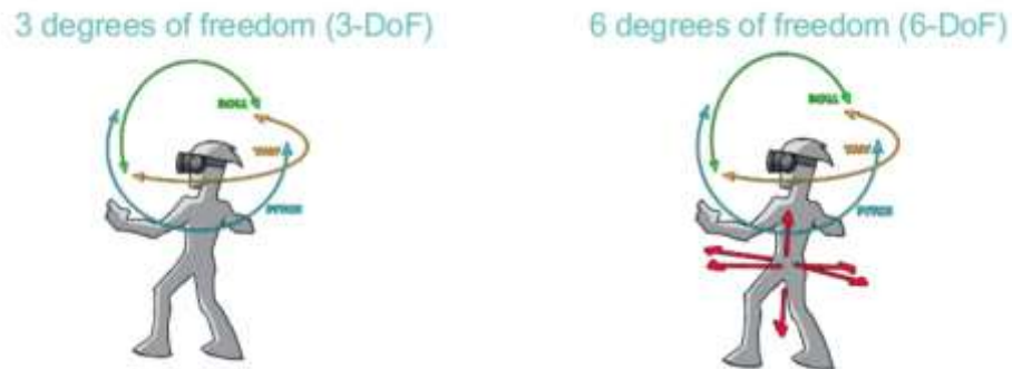
Figura 5 - Exemplos dos movimentos detectados em 3 DoF e 6 DoF.
