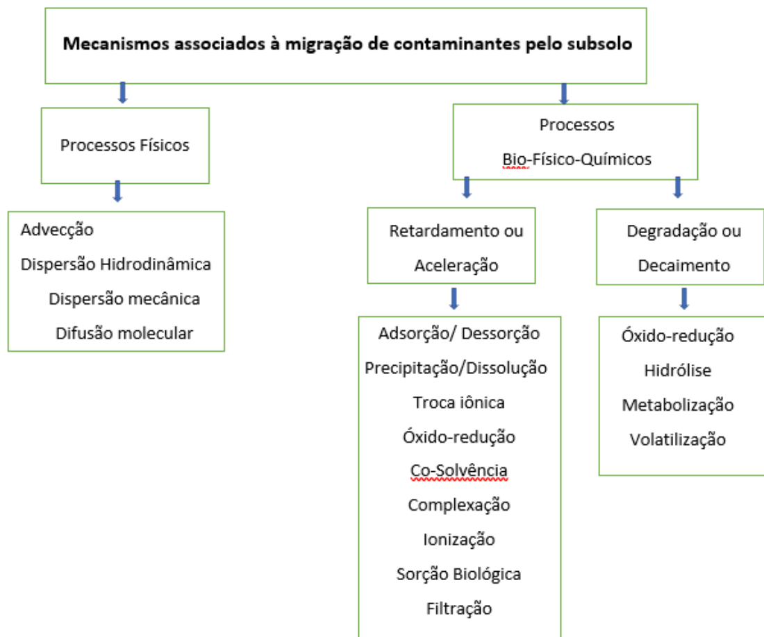
Figura 7 - Mecanismos de transporte de massa. Fonte: Adaptado de (de CAMPOS, 2001).
