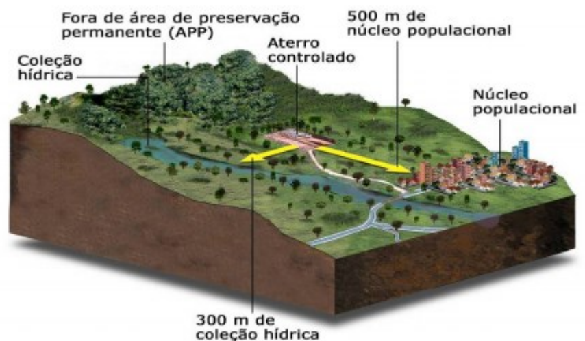
Figura 2 - Esquema de um aterro controlado. Fonte FEAM 2008.
