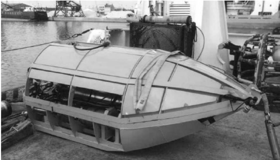
Figura 7 Estrutura metálica que é rebocada com os equipamentos de sísmica. Este equipamento em específico é denominado GAMBAS. (Danson, 2005)
