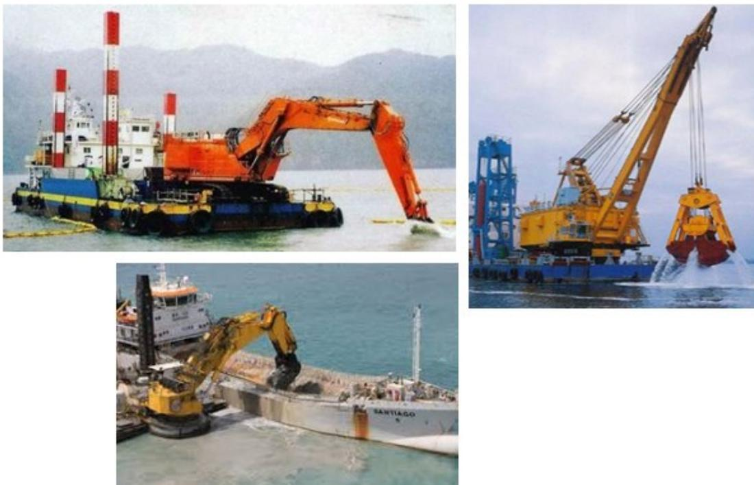
Figura 21 Exemplos de dragas mecânicas
