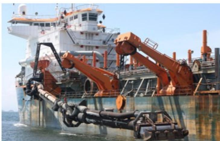
Figura 22 Draga hidráulica de sucção e recalque
