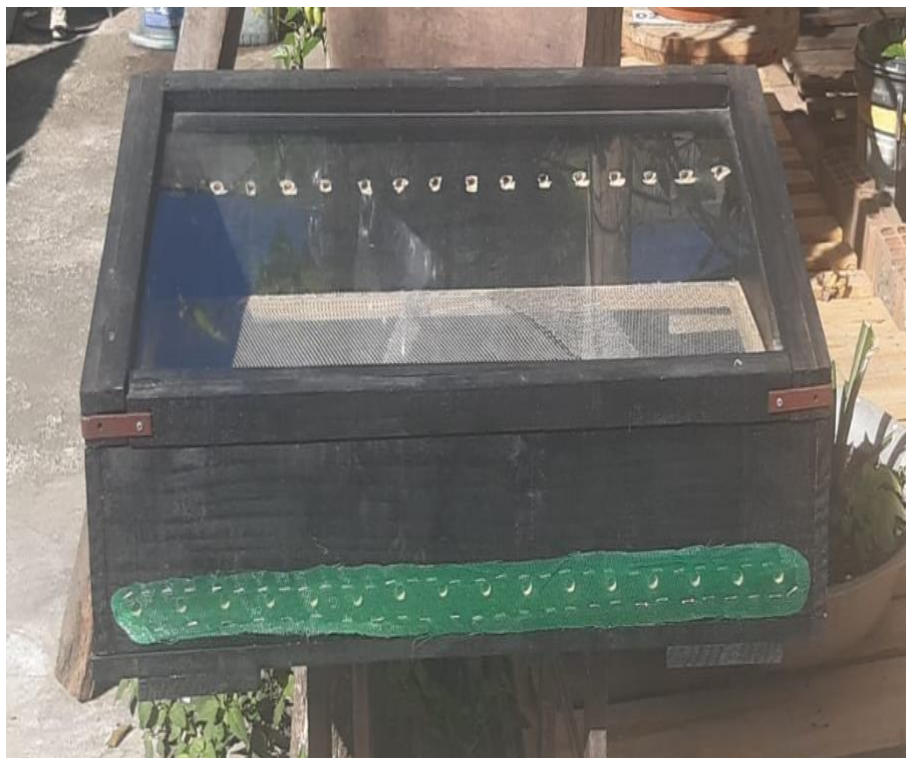
Figura 15 - Dessecador solar pronto
