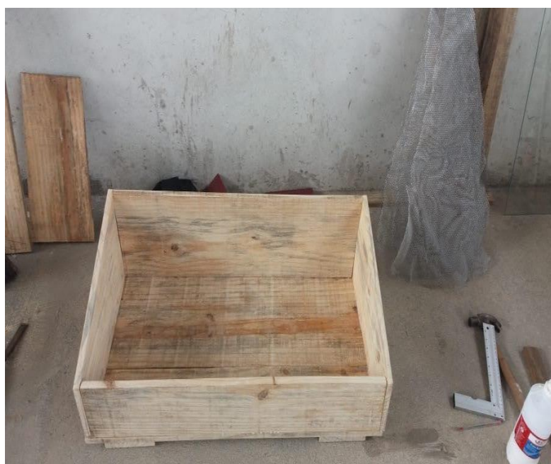
Figura 11 - Dessecador sendo medido e confeccionado
