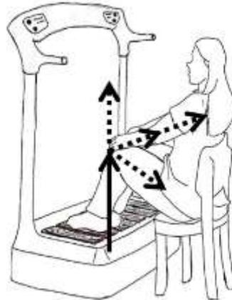
Legenda: As setas pontilhadas demonstram a decomposição da vibração mecânica para todo o corpo.
