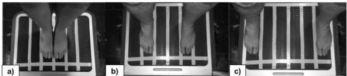
Legenda: O deslocamento pico a pico ( $D$ ) modifica de acordo com o posicionamento dos pés. a)  $D= 2,5$  mm. b)  $D= 5,0$  mm. c)  $D= 7,5$  mm.
