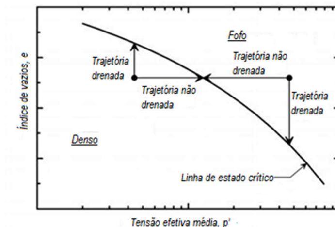
Figura 1.3 Trajetórias de tensão de carregamentos estáticos (modificado de BALBARINI, 2017).
