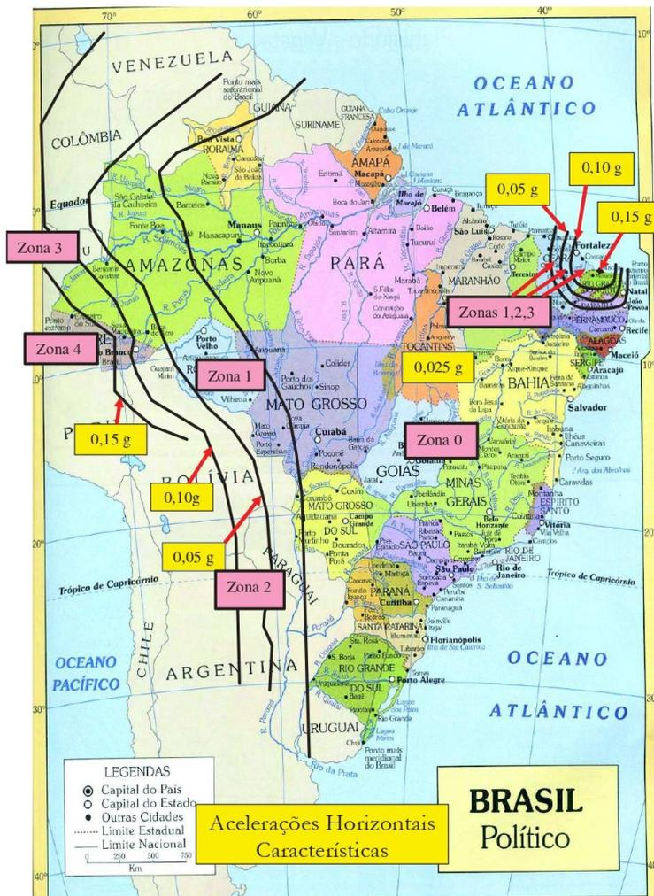
Figura 5 – Zoneamento sísmico brasileiro, segundo NBR15421 (2006) com detalhe em GN, CE e PI. (Santos e Lima, 2005).
