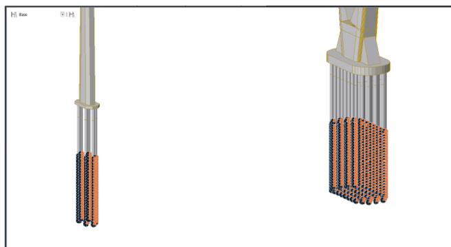
Figura I1 – Simulação da reação lateral do solo de fundação no projeto base – Subcapítulo 3.2.
