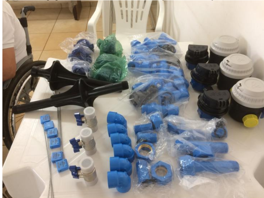
Figura 37 – Equipamentos e Materiais de Instalação e Substituição de Hidrômetros
