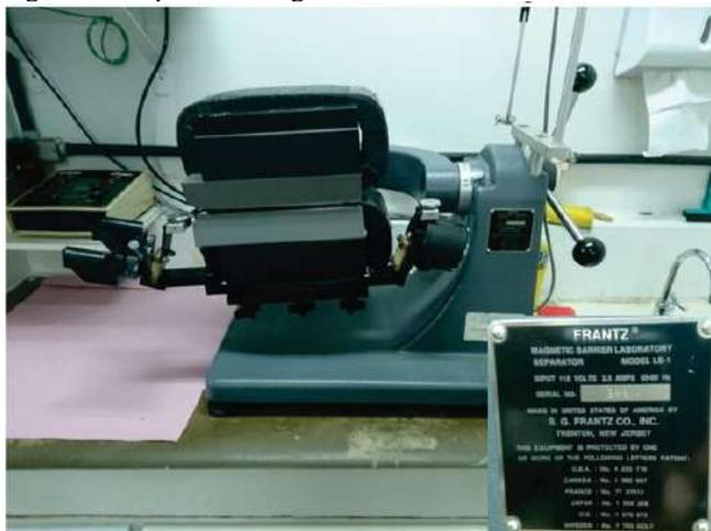
Legenda: Equipamento presente do LGPA-UERJ para separação das frações magnéticas dos produtos, pipetado e concentrado, da mesa hidrodinâmica.
