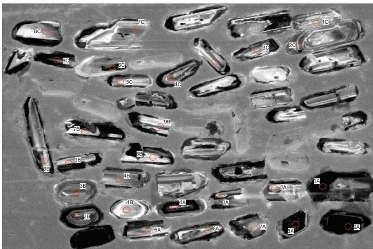
Legenda: A tabela inserida na figura corresponde as análises feitas nos grãos de zircão. O círculo vermelho (20μm a 30μm) indica o local do tiro em cada grão analisado.
