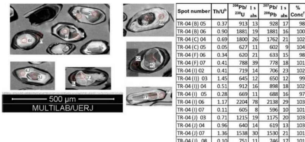
Legenda: A tabela inserida na figura corresponde as análises feitas nos grãos de zircão. O círculo vermelho (20μm a 30μm) indica o local do tiro em cada grão analisado.
