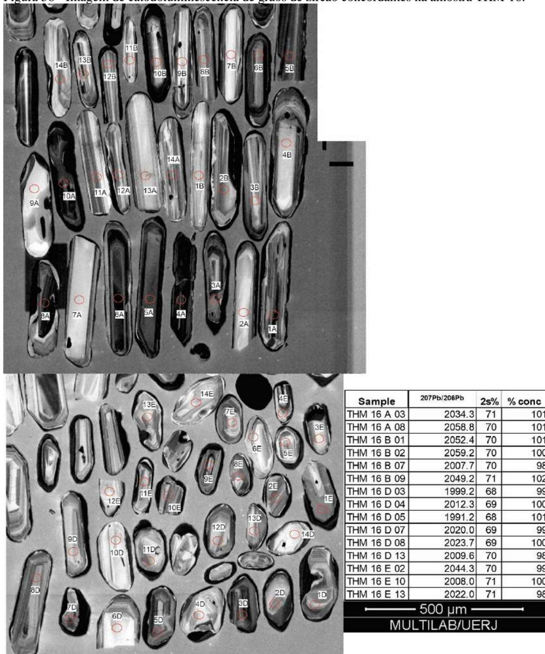
Legenda: A tabela inserida na figura corresponde as análises feitas nos grãos de zircão. O círculo vermelho (20µm a 30µm) indica o local do tiro em cada grão analisado.
