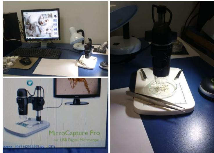
Legenda: A lupa é acoplada ao computador, que transmite a imagem através do programa Microcapture Pro. A pinça é utilizada para selecionar os fragmentos que serão utilizados no *mount*.
