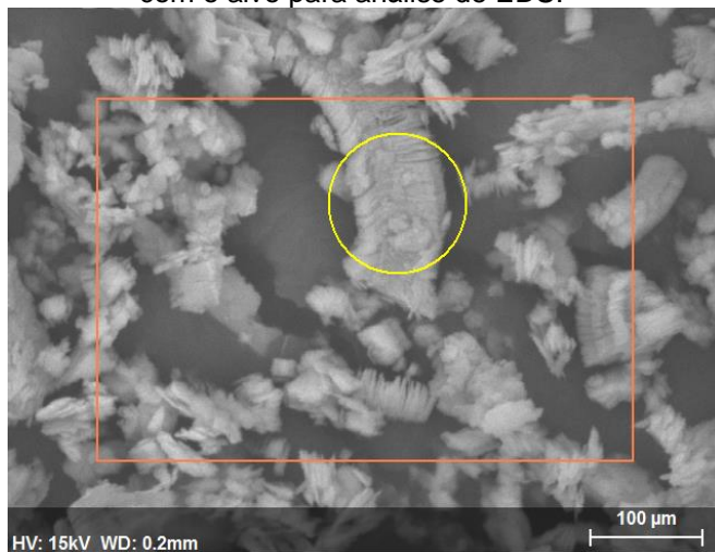
Figura 44 - Imagem obtida no microscópio eletrônico de varredura da fração < 44 \mu\text{m} do Pegmatito 3 com o alvo para análise de EDS.
