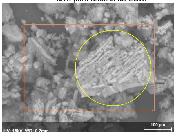
Figura 40 - Imagem obtida no microscópio eletrônico de varredura da fração < 44 \mu\text{m} do Pegmatito 2 com o alvo para análise de EDS.
