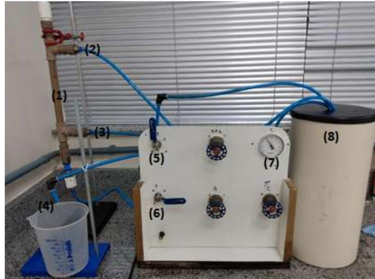
Legenda: (1) – suporte para inserção do módulo, (2) – saída do concentrado, 3 – entrada da alimentação, (4) – saída do permeado, 5 – válvula by-pass para reciclo do permeado de volta ao armazenamento, 6 – válvula para saída do permeado, 7 – manômetro, 8 – tanque de armazenamento.
