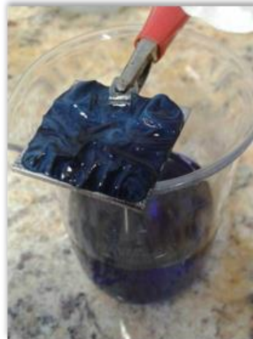
Figura 24 – Filme \text{TiO}_2/\text{QT} imobilizado em aço inox 316 sem o primer
