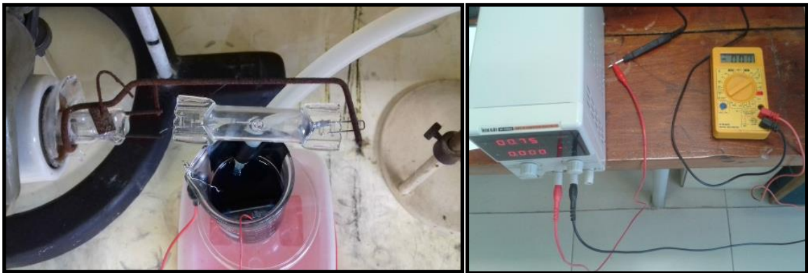
Figura 9 – Unidade reacional adaptada para o sistema fotoeletrocatalítico
