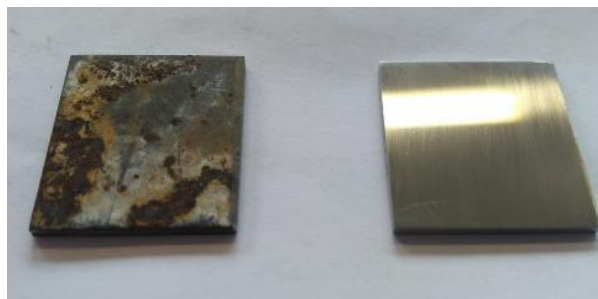
Figura 10 – Fotografia do aço carbono antes e após o procedimento de preparo
