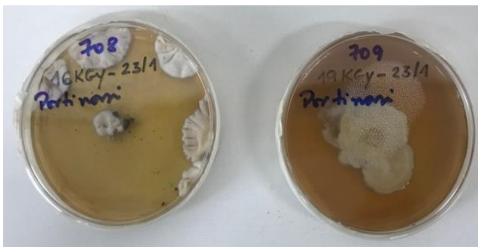
Figura 44 – Imagem da viabilidade fúngica da espécie Penicillium sp. (à esquerda) e da espécie Cladosporium sp. (à direita) após a irradiação de 16 KGy e 19 KGy, respectivamente
