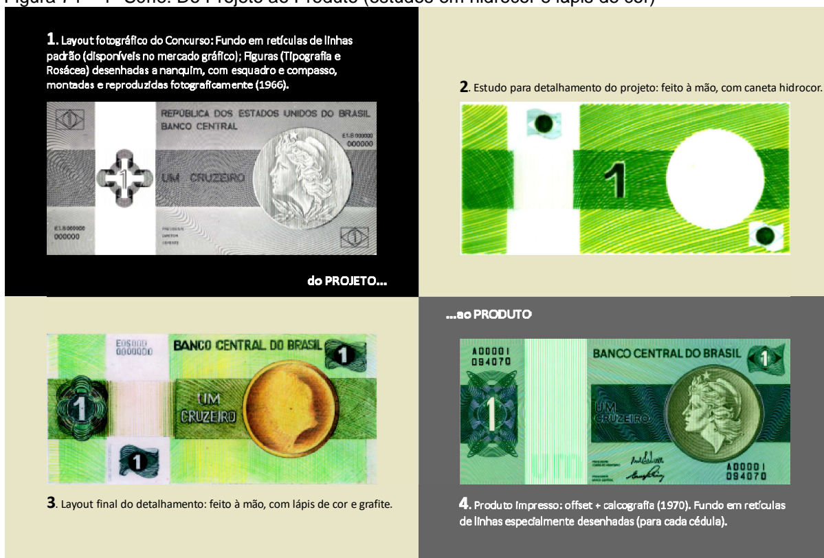
Figura 74 – 1ª Série: Do Projeto ao Produto (estudos em hidrocor e lápis de cor)
