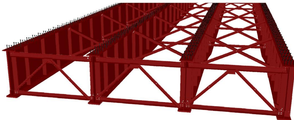
Figura 81 – Estrutura metálica da ponte com representação dos conectores de cisalhamento do tipo pino com cabeça – Projeto II [Adaptado de Pinho & Bellei (2020)].
