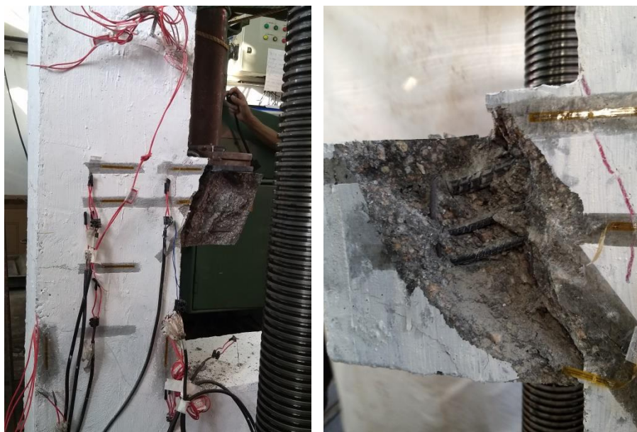
Figura 93 - Ruptura do modelo P2M2MON
