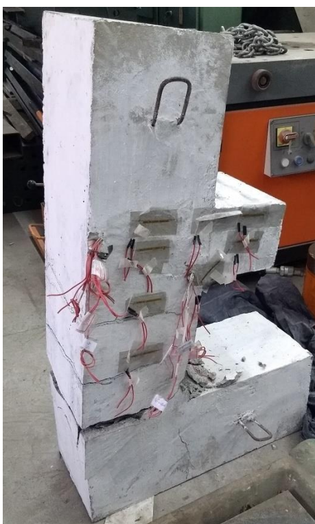
Figura 63 - Ruptura do modelo P1M1PC
