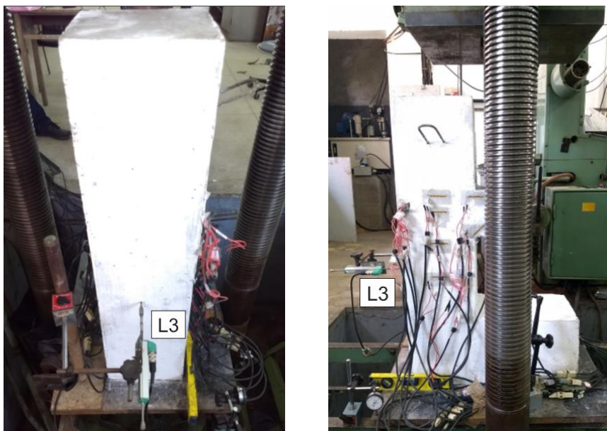
Figura 45 - Posição do transdutor L3
