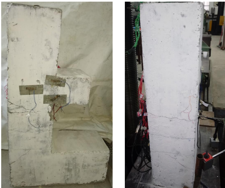
Figura 70 - Ruptura do modelo P1M2MON
