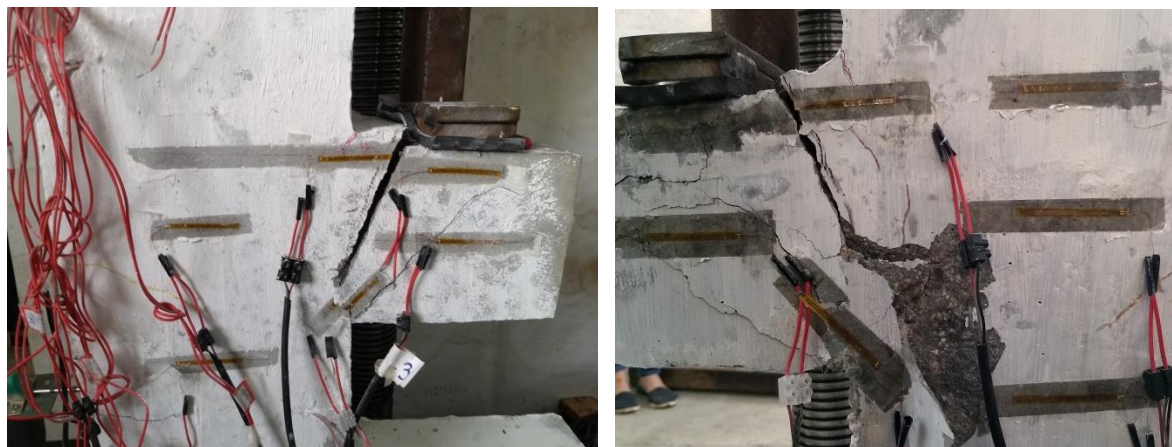
Figura 85 - Ruptura do modelo P2M1MON
