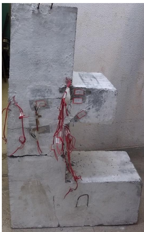
Figura 77 - Ruptura do modelo P1M2PC
