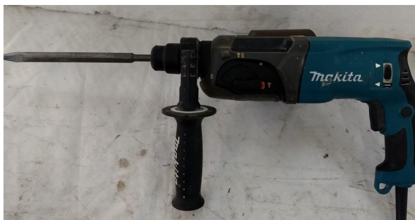
Figura 41 - Martelete mecânico utilizado para apicoar a superfície do pilar
