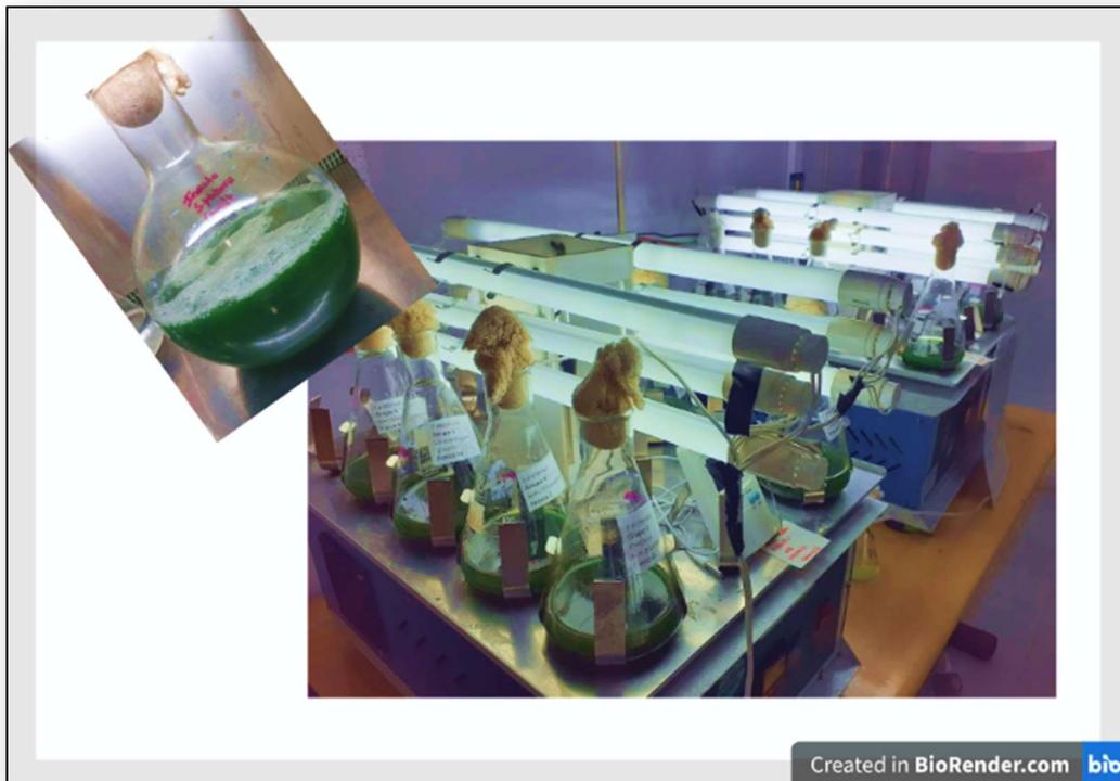
Legenda: Foi feito um rodízio aleatório entre as posições na mesa agitadora para alcançar as densidades de fluxo fotônico desejadas. Foto realizada no início do experimento com concentração inicial de biomassa em torno de 1 g.L<sup>-1</sup>
