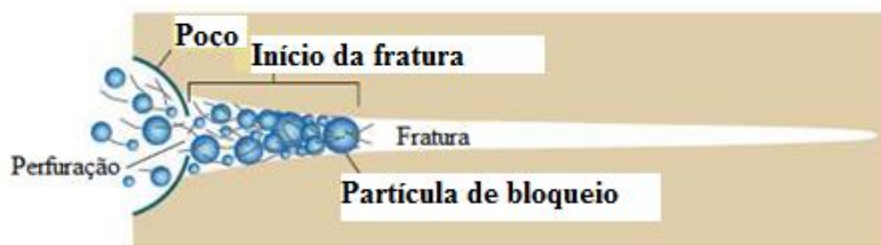
Figura 17- Infiltração do material de perda de carga (LCM) na fratura.
