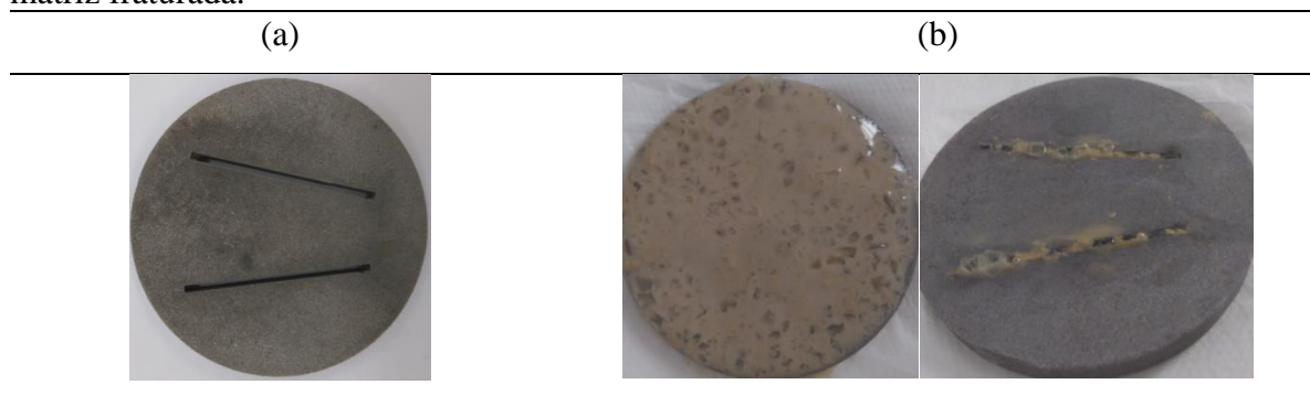
Figura 57- Imagem dos testes de filtração estática – a) matriz fraturada; b) torta formada na matriz fraturada.
