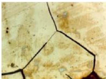
Figura 4 - Exemplo de corrosão intergranular em aço inox
