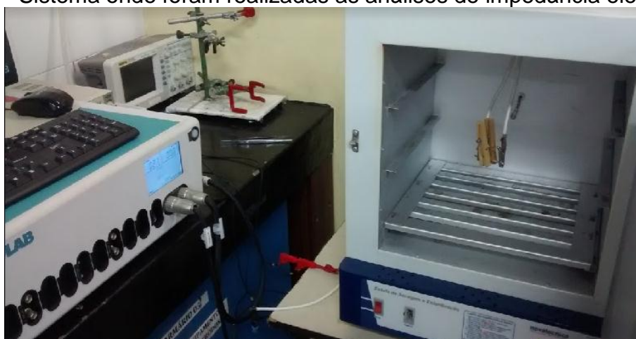
Figura 20 - Sistema onde foram realizadas as análises de impedância eletroquímica
