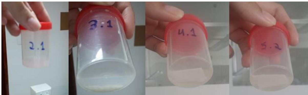
Figura 66 - Teste de inchamento do PUUB puro e com 10%, 20% e 30% de m-2HEAPr em etanol
