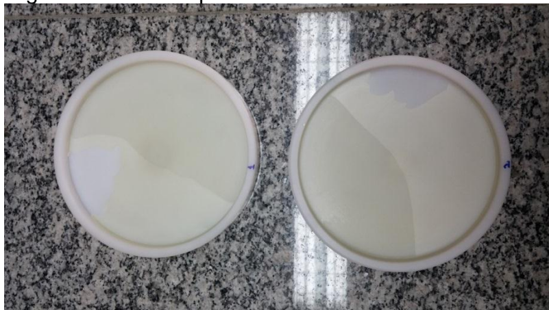
Figura 23 - PUUB após tentativa de retirada dos moldes
