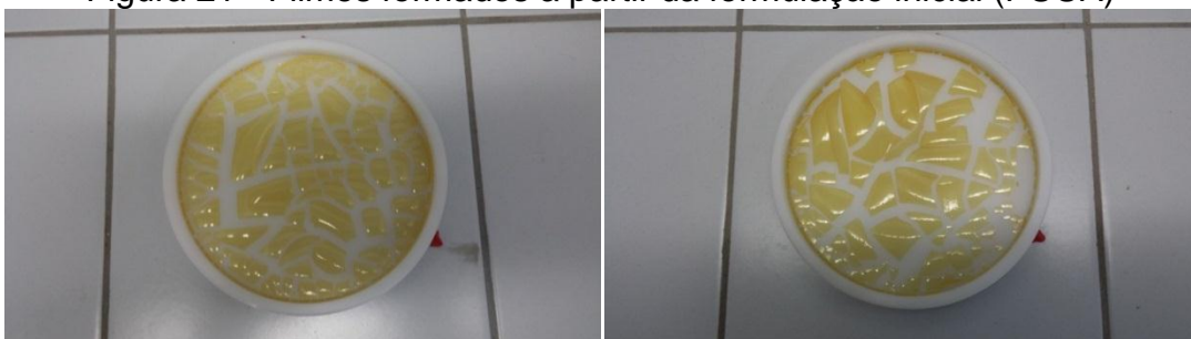
Figura 21 - Filmes formados a partir da formulação inicial (PUUA)
