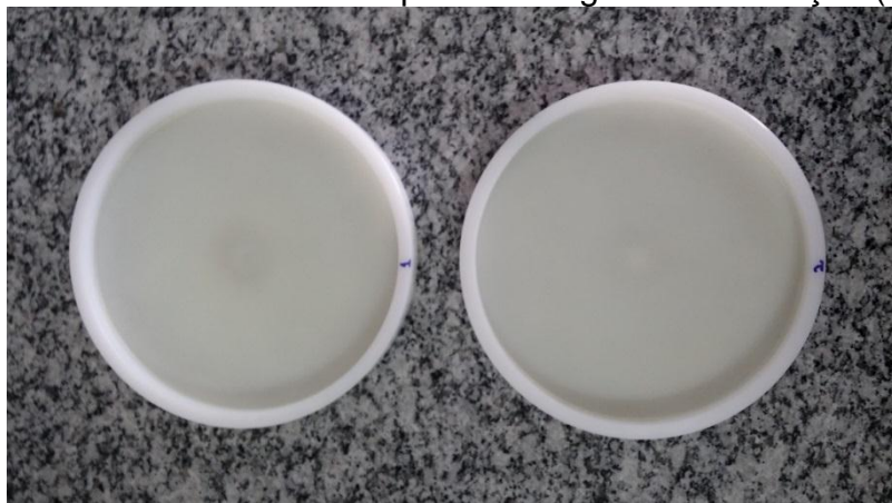
Figura 22 - Filmes formados a partir da segunda formulação (PUUB)
