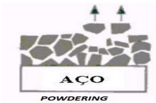
Figura 2 — Imagem ilustrativa sobre o efeito do powdering em um aço galvanizado.
