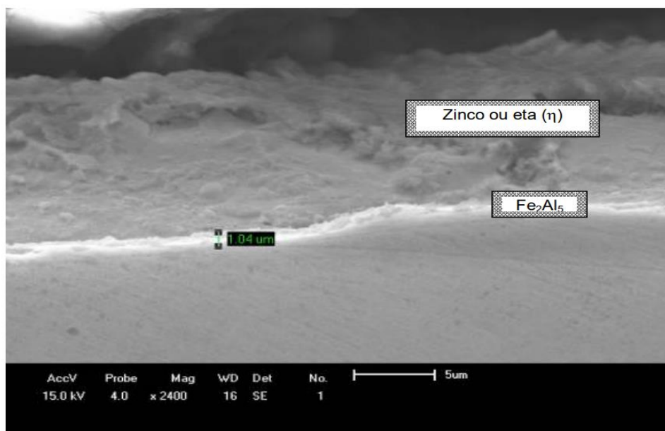
Figura 22 — Corte transversal de uma chapa galvanizada comum GI com gramatura de 100 g/m 2 a qual se observa a camada intermetálica rica em Al na região da interface.
