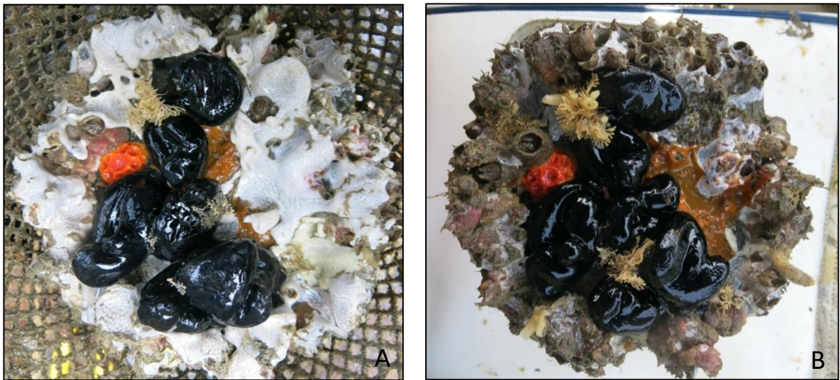
Figura 3 - Desenvolvimento da comunidade na placa de polietileno com nove meses de imersão (A). Mesma placa, com dez meses de imersão e após um mês sem a tela de proteção (B).
