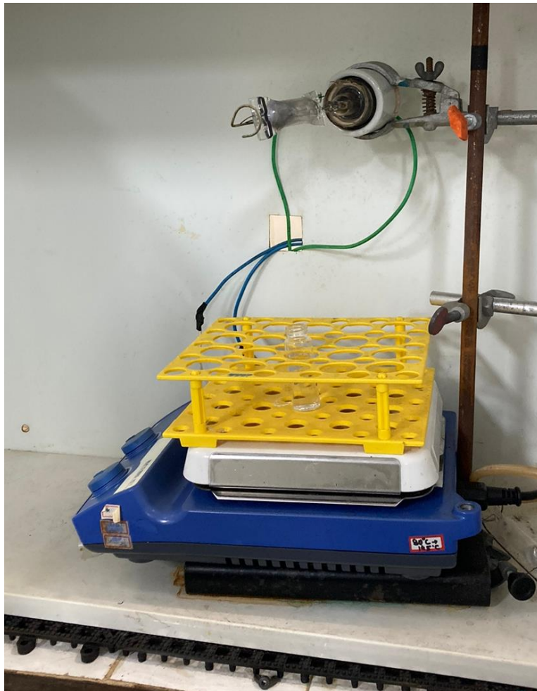
Figura 14 - Sistema para realização dos testes fotocatalíticos.
