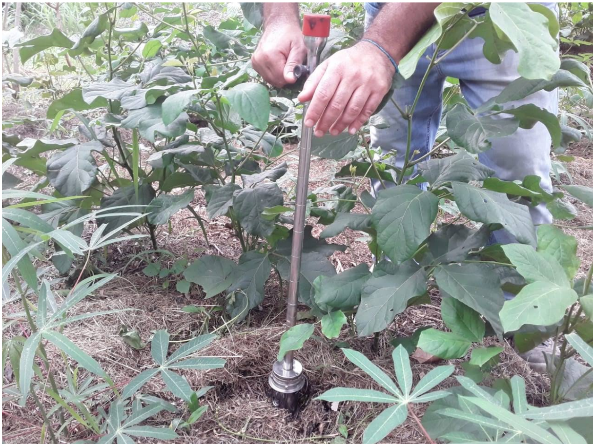
Figura 18 - Retirada de amostra indeformada
