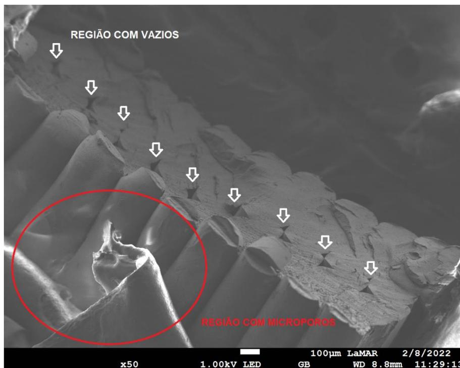
Figura 26: Imagem obtida através do MEV com a região dos microporos e dos vazios.
