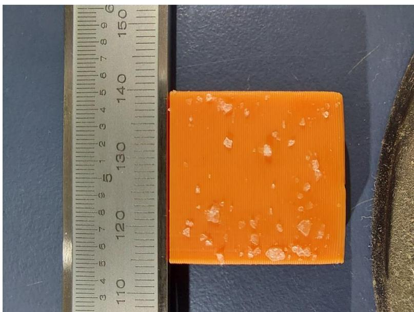
Figura 8: Placa de PLA revestida com o selante na proporção de 0,1 grama de partículas de Nitrato de Prata para cada 1mL de verniz. Fonte: O Autor.
