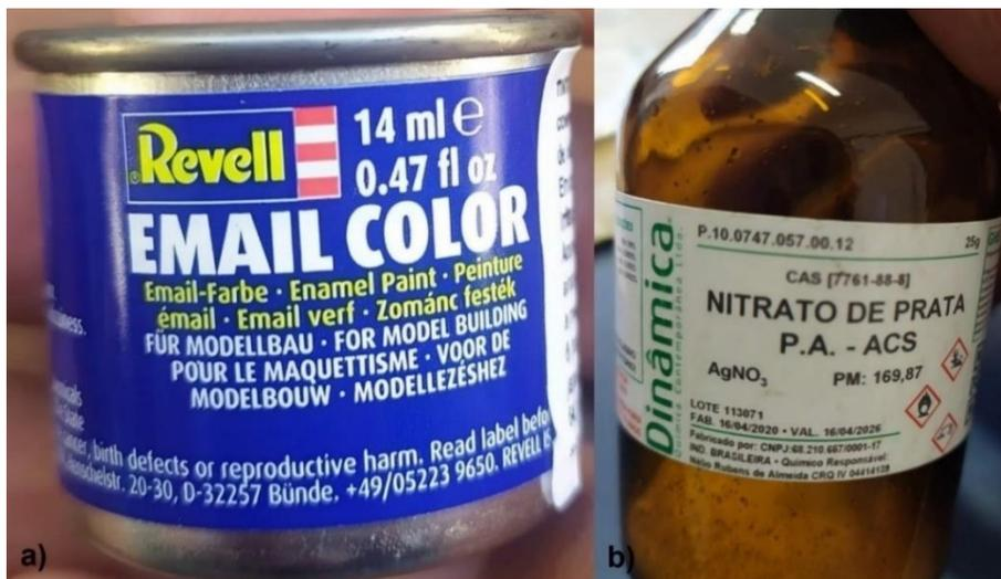
Figura 7: a) Verniz comercial usado na fabricação do selante; b) Nitrato de Prata usado na fabricação do selante. Fonte: O Autor.
