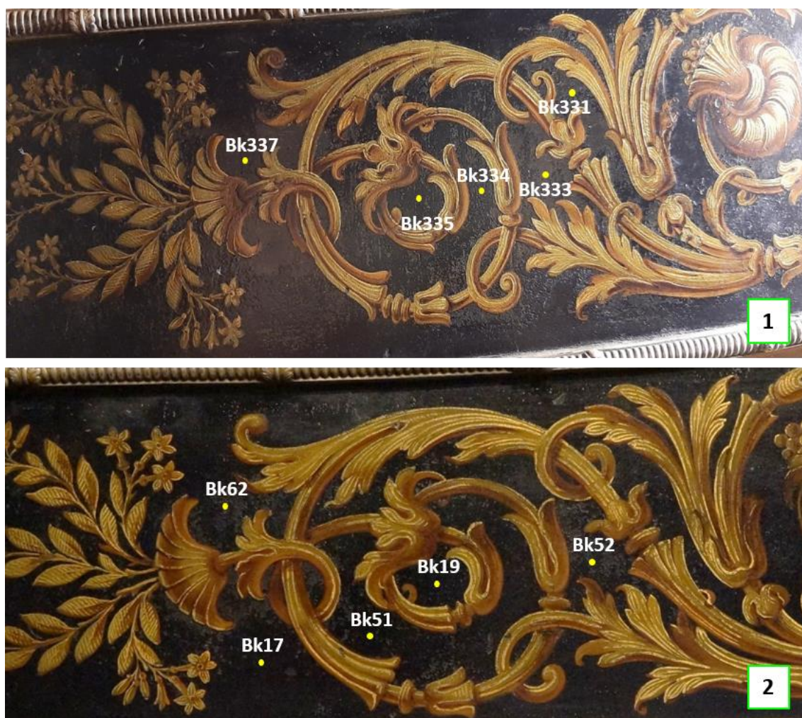
Figura 48: Pontos de XRF sobre o pigmento preto
