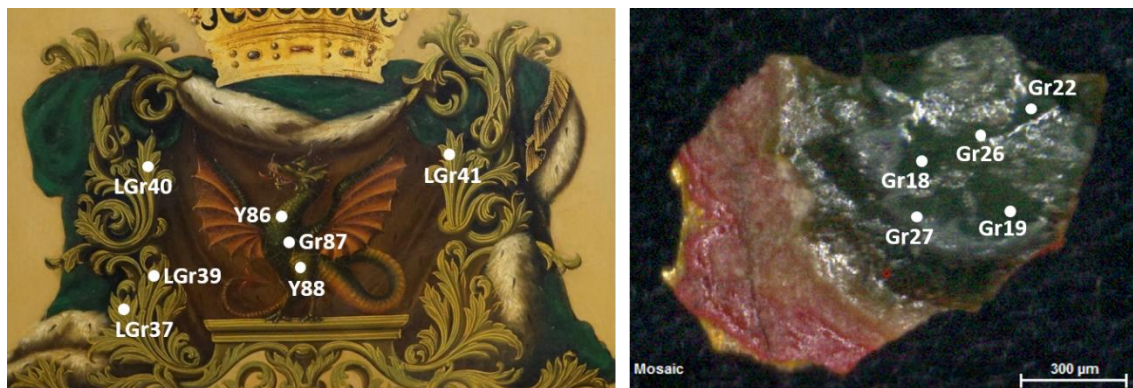
Figura 68: Pontos de XRF obtidos nas regiões C e no fragmento obtido da região B
