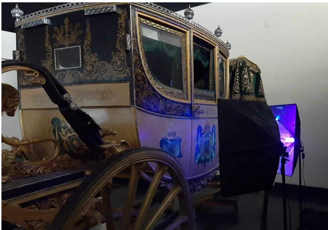
Figura 21: Arranjo experimental para aquisição de fotos por fluorescência UV
