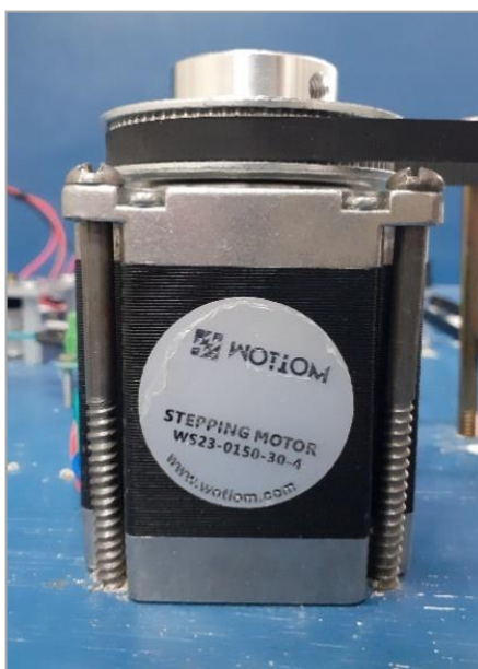
Figura 28 – Motor de passo Wotiom, modelo WS23-0150-30-4.
