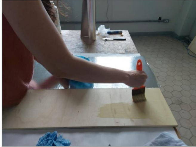
Figura 8 – Processo de revestimento com papel alumínio.
