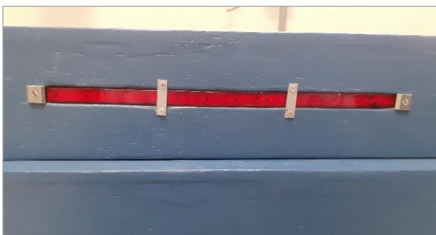
Figura 30 – Fita de LED instalada na parte frontal do equipamento.
