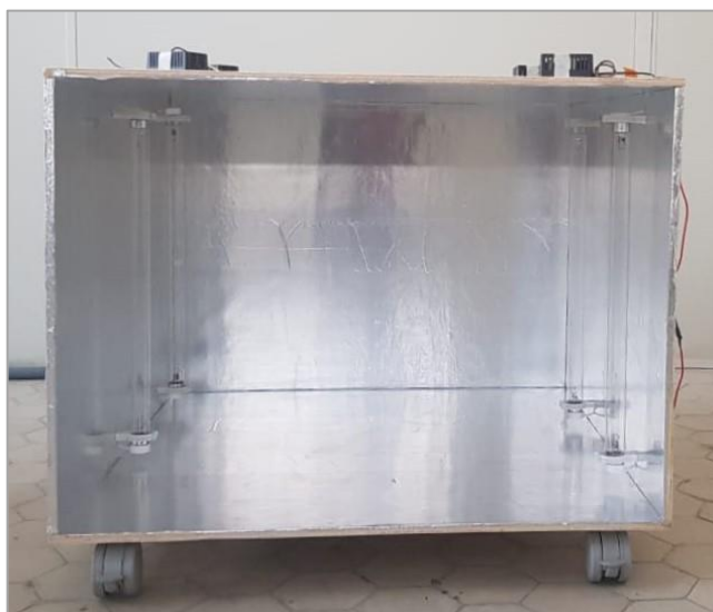
Figura 12 – Visão frontal das lâmpadas UVC instaladas na área de irradiação da CHC.
