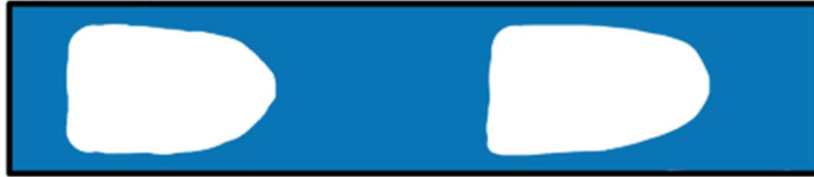
Figura 8 – Padrão de escoamento intermitente
