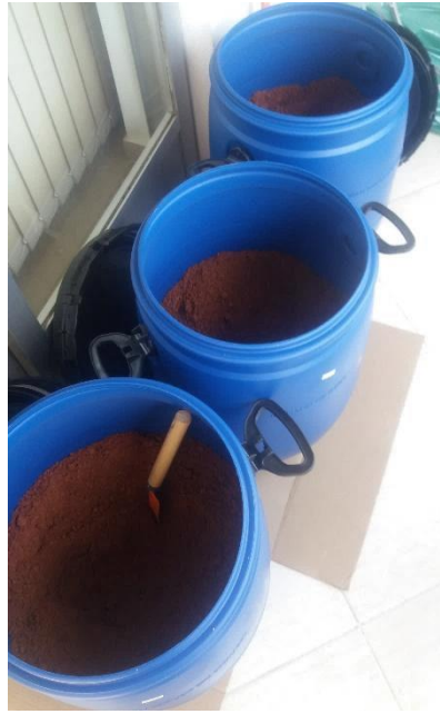
Figura 8 – Solo armazenado em bombonas plásticas.
