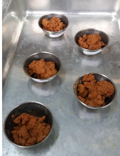
Figura 12 – Solo úmido em cápsulas metálicas.
