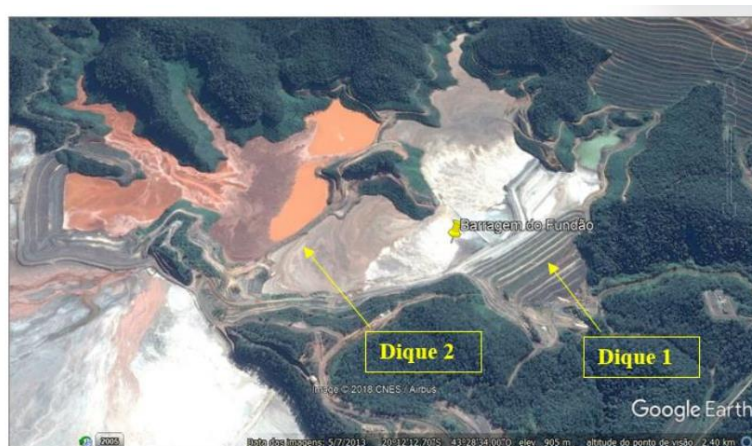
Figura 53. Esquema de separação de rejeitos (Dique 1 e 2 de Fundão) - Google Earth (Fabre, 2019).
