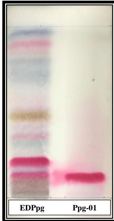
Legenda: A HPTLC foi desenvolvida em placa de sílica gel 60 de alta resolução, utilizando diclorometano: acetato de etila (9:1 v/v) como fase móvel. As placas foram reveladas para terpenoides com o reagente vanilina-sulfúrico (1% vanilina em etanol:10% ácido sulfúrico em etanol 1:1 v/v).
