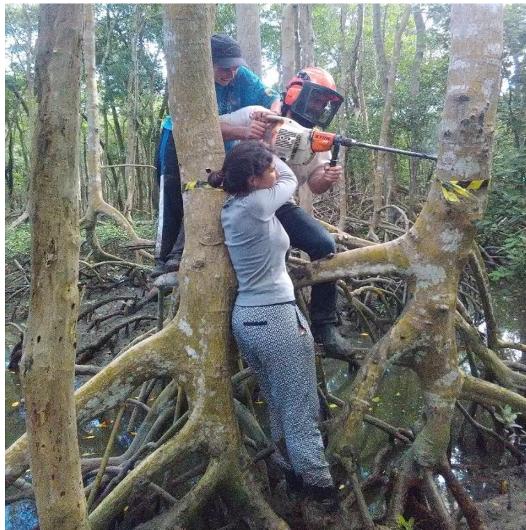
Figura 6 - Radio extraído de um indivíduo, com trado motorizado
