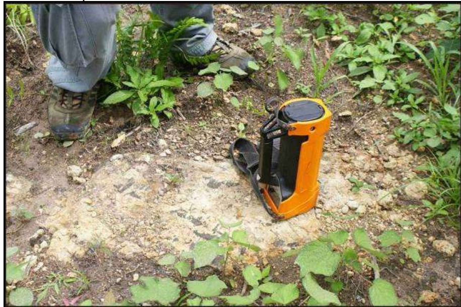
Figura 10 – Demonstração da metodologia utilizada no levantamento, com o aparelho encostado no chão.
