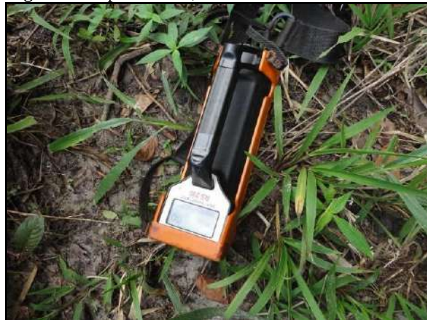
Figura 9 – Espectrômetro, modelo RS-230BGO
