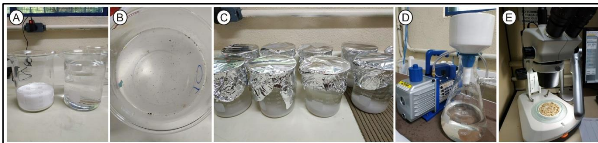
Figura 22 - (A e B) - Preparação e adição de solução salina; (C) –decantação das amostras de água (D) –filtragem; (E) - análise na lupa binocular
